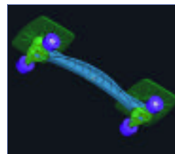
Modelo de Snake board. Sus dos plataformas giratorias añaden versatilidad al producto.
