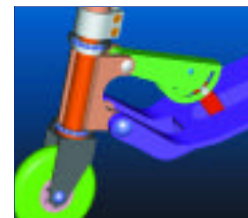
Detalle del sistema de plegado de patinete tipo «Skate Scooter». A través del corte se pueden observar los componentes que forman la horquilla de dirección.
